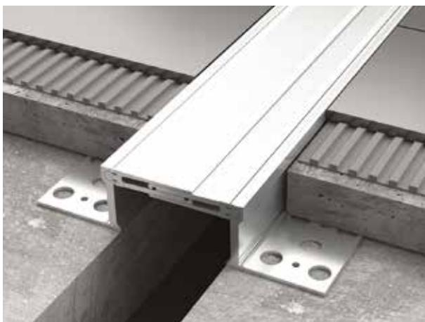
Juntas estructurales de deslizamiento totalmente realizadas en aluminio. Diseñadas para soportar movimientos estructurales de edificios grandes o compuestos. Deben instalarse en los espacios existentes entre dos partes semi unidas que componen un mismo edificio o entre dos tramos diferentes. Son capaces de conectar estos espacios entre sí permitiendo movimientos verticales, horizontales y transversales, dependiendo de los asentamientos del edificio, ya sean cílicos o permanentes.
